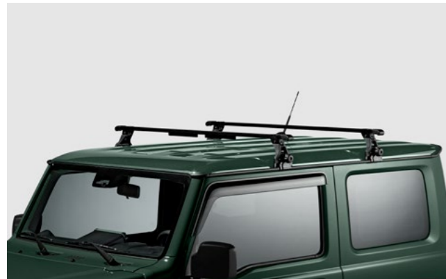
Art.-Nr. 99176-78R10-000 Schwarzer Rechteckprofilstahl mit Endkappen. Max. Dachlast 30 kg. Eigengewicht: 6,3 kg. Abmessungen: 70 cm × 144,4 cm × 18,3 cm.
