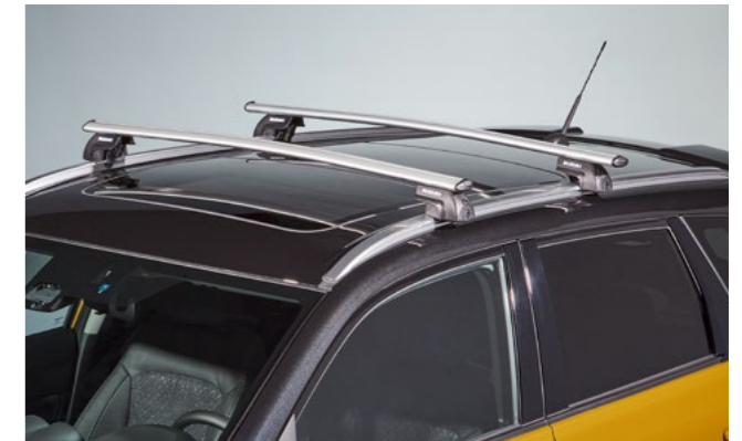
Art.-Nr. 78901-54P00-000 Bestehend aus Aluminiumschienen mit T-Slot, abschließbar. Eigengewicht: 4,4 kg. Max. Dachlast: 75 kg.
