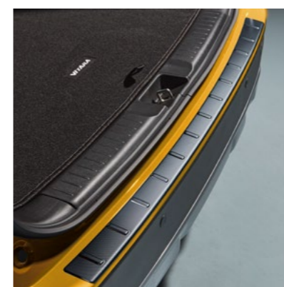
Art.-Nr. 990E0-54P51-000 Schwarz. Aus langlebigem Thermoplast, schützt beim Be- und Entladen vor Kratzern.
